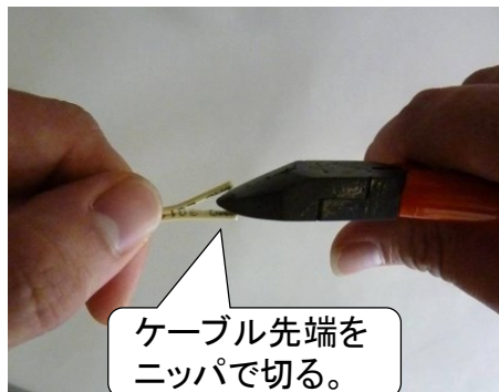
—A.ケーブルの先端切出し—
