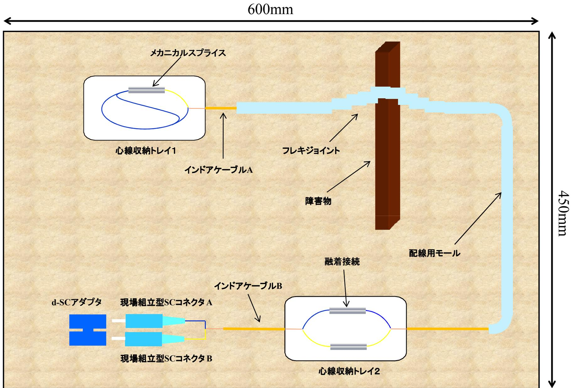
図2 光ケーブル配線作業(参考図)
