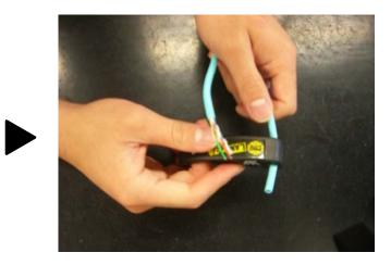
ケーブルを折り曲げ、片方の被覆を剝いて、次に他方の被覆を剥く→OK ※このとき、ケーブルの曲げ半径は問わない。
